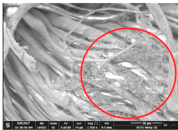
Рис. 7. СЭМ-изображения поверхности ХБТ: а – модифицированной сополимером поли(ГМА-со-ЛМА) (x1600); б – модифицированной сополимером поли(ГМА-со-ЛМА) после 80 циклов абразивного действия (x1500)
